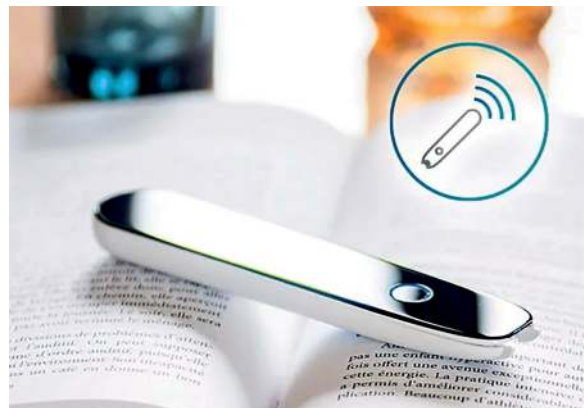
Lápiz lector portátil con escaneo y lectura en voz alta de texto impreso, diseñado para facilitar el acceso a la información a personas con discapacidad visual o dislexia.
